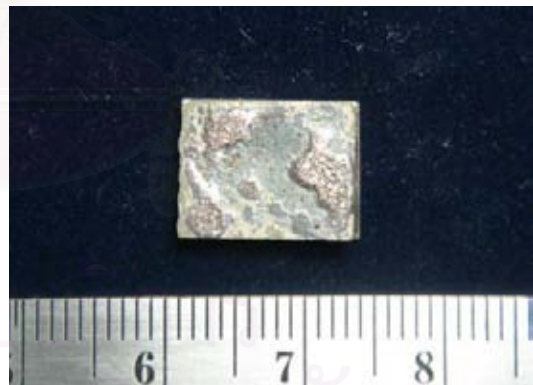
รูปที่ 4.1 ภาพถ่ายชิ้นงานนิกเกิลผ่านการทำอะลูมิเนียมไนซิง ที่อุณหภูมิ 1000 ^{\circ}\text{C} เป็นเวลา 4 ชม. อัตราส่วนผสมระหว่าง Al:Al 2 O 3 โดยน้ำหนักเป็น 5:5 ก.) ขนาดผง 42 \mu\text{m} ข.) ขนาดผง 3 \mu\text{m}
