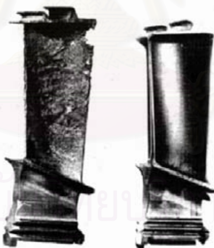
รูปที่ 2.11 ใบพัดเทอร์ไบน์ ที่ผ่านการใช้งาน 2500 ชั่วโมง (ไม่เคลือบ/เคลือบ NiAl) [2]
