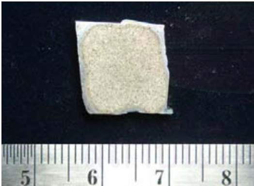
รูปที่ 4.1 ภาพถ่ายชิ้นงานนิกเกิลผ่านการทำอะลูมิเนียมไนซิง ที่อุณหภูมิ 1000 ^{\circ}\text{C} เป็นเวลา 4 ชม. อัตราส่วนผสมระหว่าง Al:Al 2 O 3 โดยน้ำหนักเป็น 5:5 ก.) ขนาดผง 42 \mu\text{m} ข.) ขนาดผง 3 \mu\text{m}
