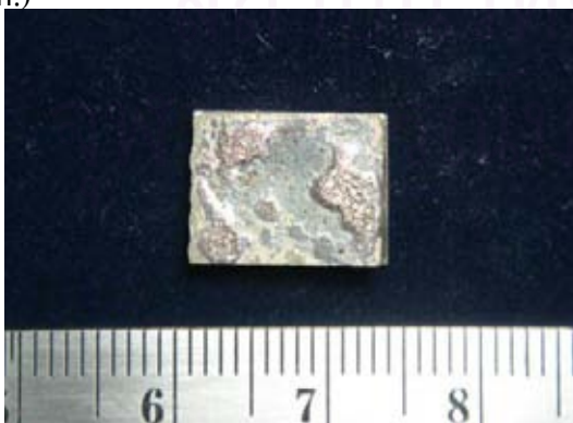
รูปที่ 4.3 ภาพถ่ายชิ้นงานผ่านการทำอะลูมิเนียมไนซิงบนโลหะนิกเกิล ที่ 1000^{\circ}\text{C} เป็นเวลา 4 ชั่วโมง โดยอัตราส่วนผสม Al:Al 2 O 3 ก) 10:0, ข) 7:3, ค) 5:5, ง) 3:7 โดยน้ำหนัก
