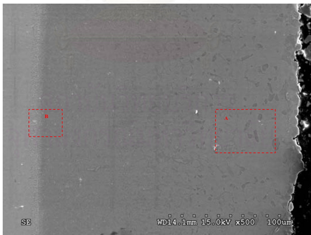
รูปที่ 4.39 ผลการตรวจสอบชั้นเคลือบบริเวณ A ของชิ้นงาน รูปที่ 4.37 ก.) ด้วย SEM
