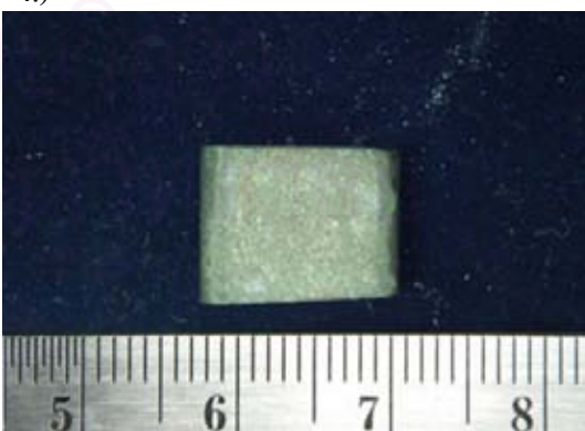
รูปที่ 4.4 ภาพถ่ายชิ้นงานผ่านการทำอะลูมิเนียมในเชิงบน In 738 ที่ 1000^{\circ}\text{C} เป็นเวลา 1 ชั่วโมง โดยอัตราส่วนผสม \text{Al}:\text{Al}_2\text{O}_3 ก) 10:0, ข) 7:3, ค) 5:5, ง) 3:7 โดยน้ำหนัก
