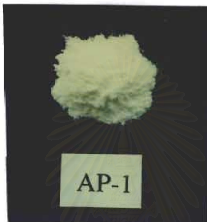
รูปที่ 13 แสดงลักษณะ EPS ของ AP-1 ที่ผ่านการทำแห้งโดยใช้เครื่อง freeze dryer
