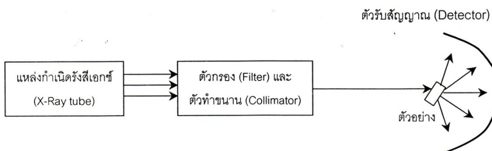
ภาพที่ 2.9 องค์ประกอบของเครื่องมือที่ใช้เทคนิคการเลี้ยวเบนของรังสีเอกซ์ชนิดตัวอย่างเป็นผง (จตุพร และ นุรักษ์, 2547)
