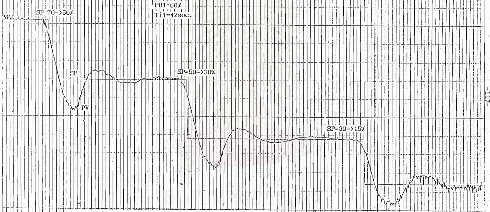
รูปที่ 6.17 กราฟแสดงผลของโปรเซสเมื่อมีการเปลี่ยนแปลงค่าเป้าหมาย ในการควบคุมป้อนกลับแบบง่าย ๆ
