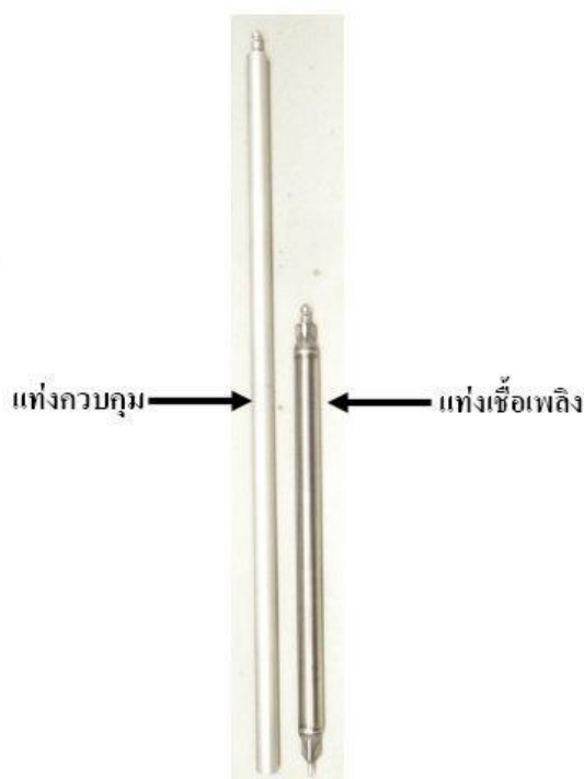
ภาพที่ 2.15 เปรียบเทียบขนาดแท่งควบคุมและแท่งเชื้อเพลิงของเครื่องปว.-1/1
