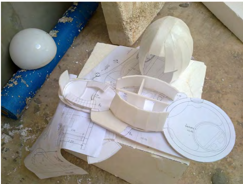
ภาพที่ 4-16 แบบก่อสร้างและหุ่นจำลองประกอบเพื่อการก่อสร้าง
