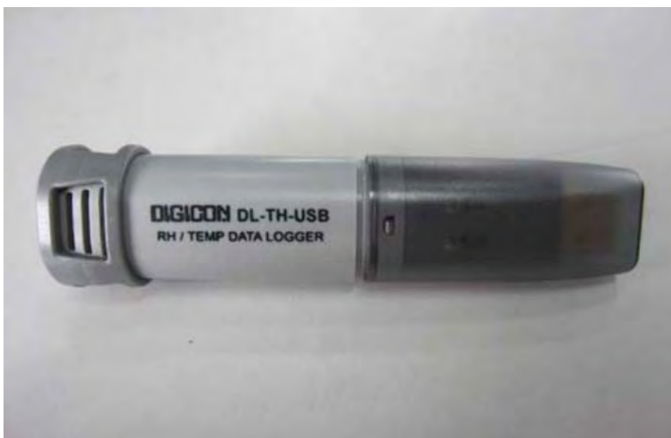
ภาพที่ 3-2 แสดงเครื่องวัดอุณหภูมิและความชื้นสัมพัทธ์ รุ่น DIGICON Model: DL-TH-USB
