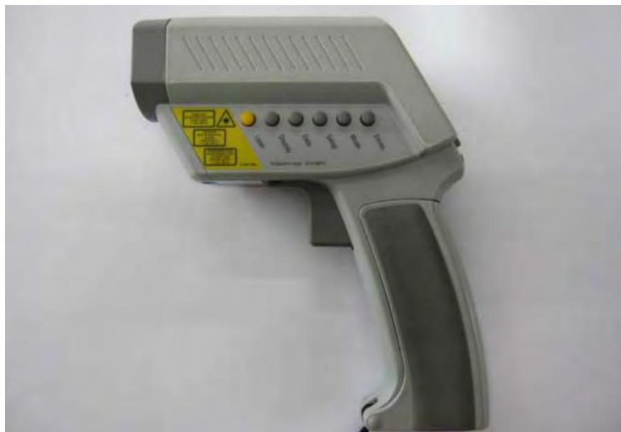
ภาพที่ 3-1 แสดงเครื่องมือวัดอุณหภูมิพื้นผิววัสดุด้วยรังสีอินฟราเรด รุ่น testo 860-T2
