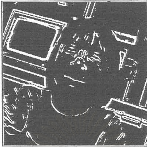
รูปที่ 3.14 ภาพผ่านการตรวจรู้ขอบแบบแคนนี่
