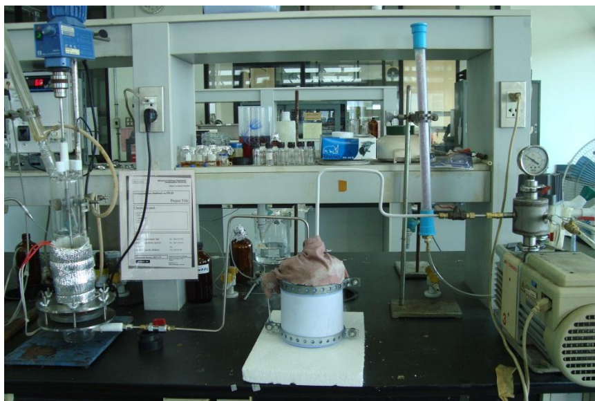
ภาพที่ 3.5 เครื่องปฏิกรณ์เมมเบรนโคไตซานต่อเข้ากับปั๊มสุญญากาศ
