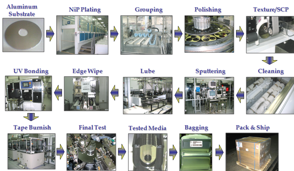
ภาพที่ 4.6 กระบวนการผลิตและตรวจสอบ Media
