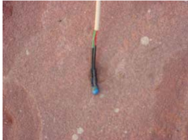
รูปที่ 3.7 แสดงวิธีการติดตั้งหัวเทอร์มิสเตอร์ที่ผิวนอกของวัสดุ
