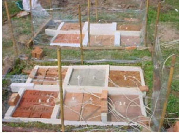
รูปที่3.5 การทดลองกลางแจ้งแสดงแผ่นกั้นลมรอบพื้นที่ทดสอบ(ขวานบน)
