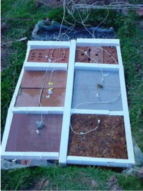
รูปที่3.5 การทดลองกลางแจ้งแสดงแผ่นกั้นลมรอบพื้นที่ทดสอบ(ขวานบน)
