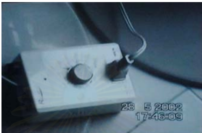
ภาพ 3-10 แสดงเครื่องปรับการจ่ายกำลังไฟฟ้า
