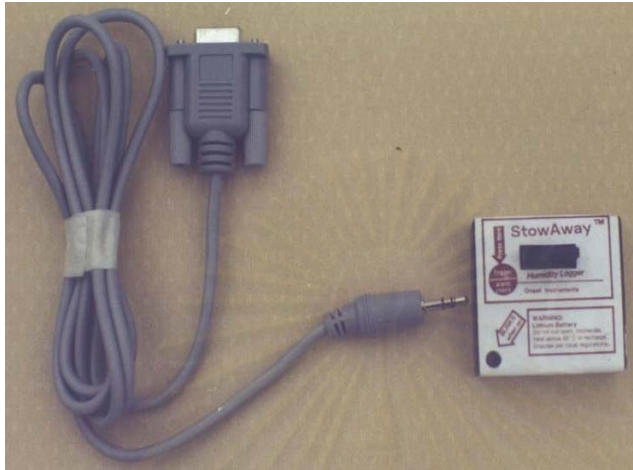
ภาพ 3-12 เครื่องวัดความชื้น stowaway data logger
