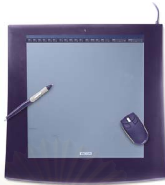
รูปภาพ 3.8 อุปกรณ์รับข้อมูลด้วยปากกาอิเล็กทรอนิกส์สำหรับงานออกแบบและงานกราฟิก (แหล่งที่มา: http://www.wacom.com )
