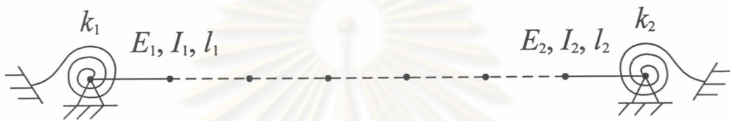
รูปที่ 2.11 ชิ้นส่วนคานที่มีจตุรกรรับข้างหนึ่งเป็นข้อหมุนสปริง
