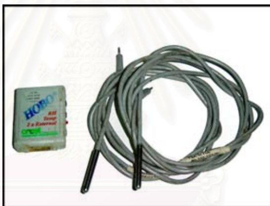
รูปที่ 3.1 อุปกรณ์วัดความอุณหภูมิและความชื้นสัมพัทธ์ ( data logger)
