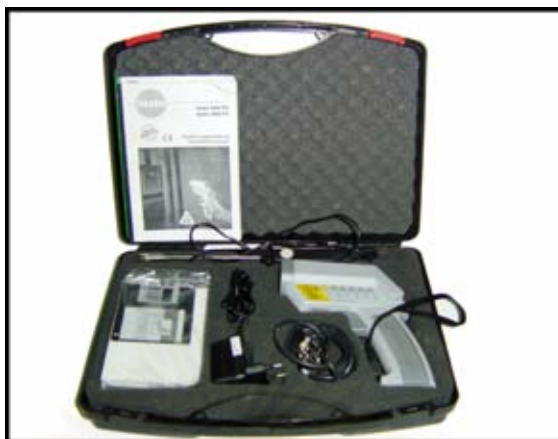
รูปที่ 3.2 อุปกรณ์วัดอุณหภูมิพื้นผิวระยะไกล ชนิดปืน (infrared gun)
