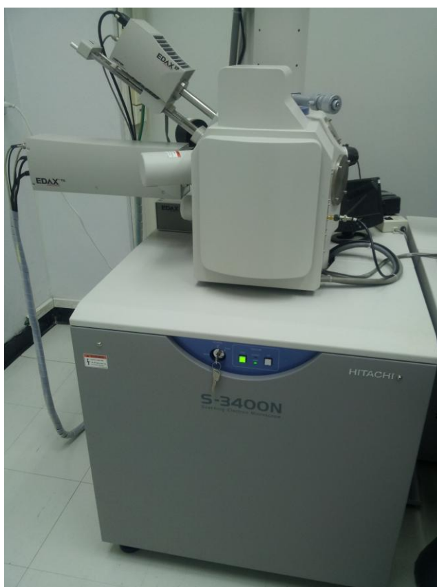
ภาพที่ ๑.7 เครื่อง Scanning Electron Microscopy (SEM) Hitachi model S-3400N
