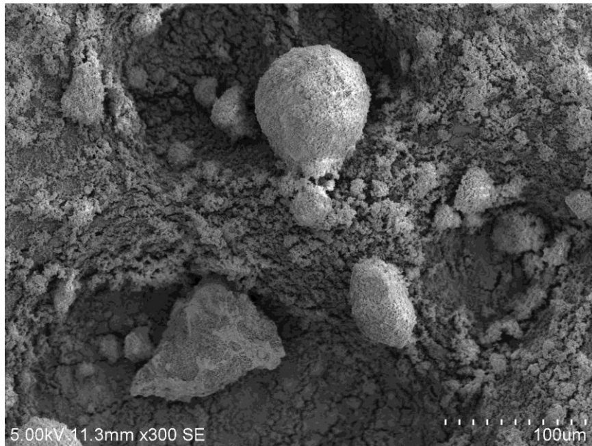
ภาพที่ 4.4 ผลวิเคราะห์ลักษณะรูปร่างของพื้นผิวของฝุ่นจากเตาหลอมอาร์คไฟฟ้า ตัวอย่าง EAFD.1 ที่กำลังขยาย 300 เท่า
