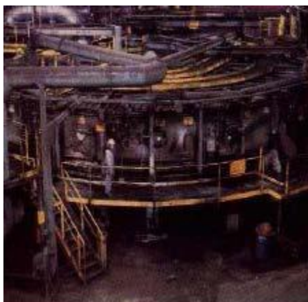
ภาพที่ 2.3 Rotary hearth furnace (RHF) (R. Juergen, 2007)
