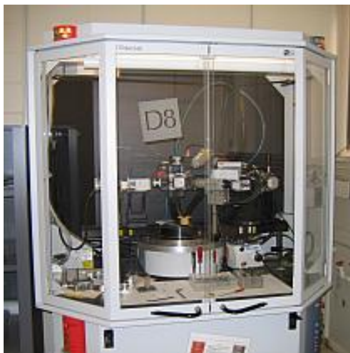
ภาพที่ ๑.2 เครื่อง X-Ray Diffraction (XRD) รุ่น Bruker AXS Model D8 Discover
