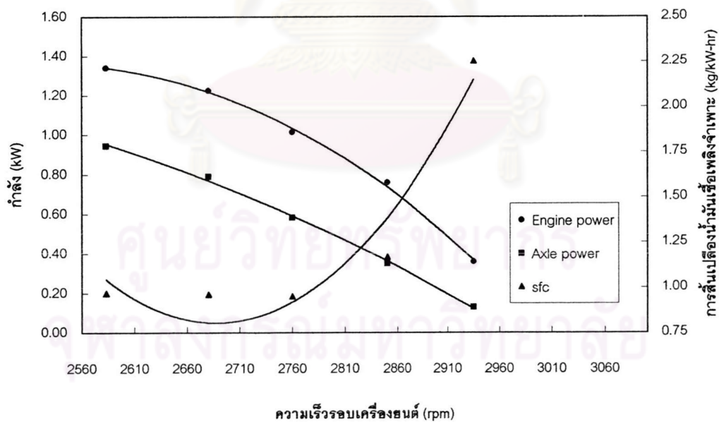
รูปที่ 6.26 การให้ภาระที่เพลาล้อในลักษณะของการลากรถพ่วง เกียร์ 4 ความเร็วรอบเครื่องยนต์ ขณะไม่มีภาระเป็น 3000 รอบต่อนาที
