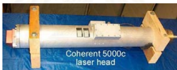
รูปที่ 17 แสดงส่วนประกอบหลักของเครื่อง ultrapulse CO 2 laser
