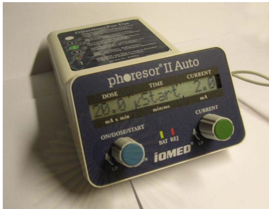
รูปที่ 47 แสดงการตั้งค่ากระแสไฟและเวลาที่จะทำ iontophoresis
