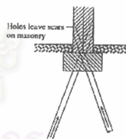
ภาพ 4-14 อธิบายการตอกเข็มขนาดเล็ก (ภาพจากหนังสือ Structural Aspects of Building Conservation โดย Poul Beckmann)
