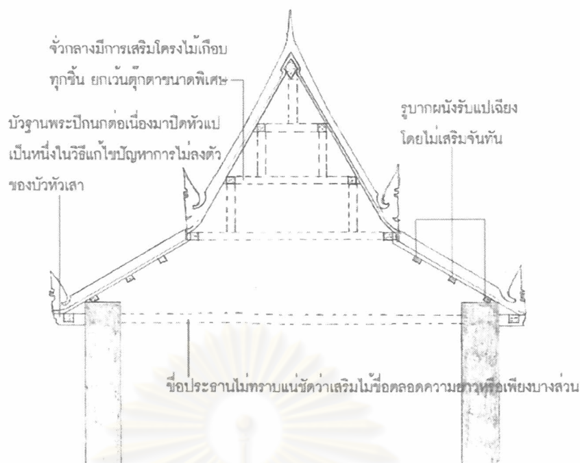
ภาพ 4-24 แบบสันนิษฐาน การเสริมโครงไม้ภายในผนังด้านสกัด (ตามเส้นประ)และรายละเอียดการวางชิ้นส่วนโครงหลังคาลงบนผนังหน้าบ้าน
