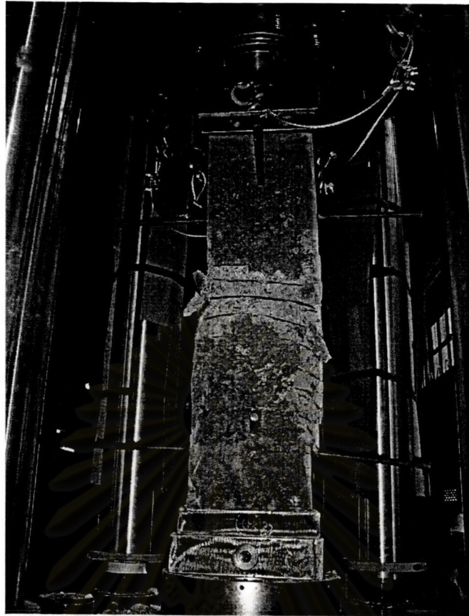
รูปที่ 4.20 ตัวอย่างทดสอบหลังการทดสอบที่เกิดการวิบัติแบบเฉือน ระบายท่ามุม 60 กับแนวราบ
