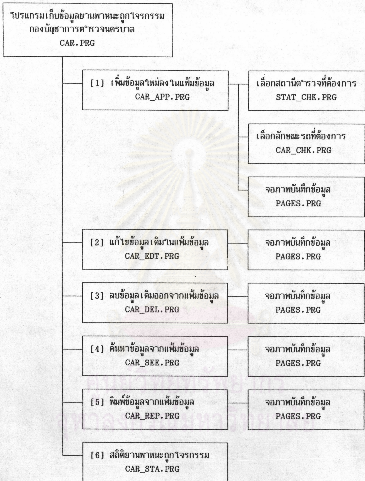
รูปที่ ข.1 ผังแสดงการทำงานของโปรแกรมเก็บข้อมูลยานพาหนะถูกโจรกรรม
