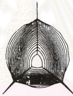
รูปที่ 2.19 แสดงรูปแบบการหดตัวของเกรนใน 2 มิติ จนกลายเป็น triple junction
