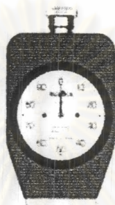
รูปที่ 3.10 เครื่องทดสอบความแข็ง ชนิด shore C
