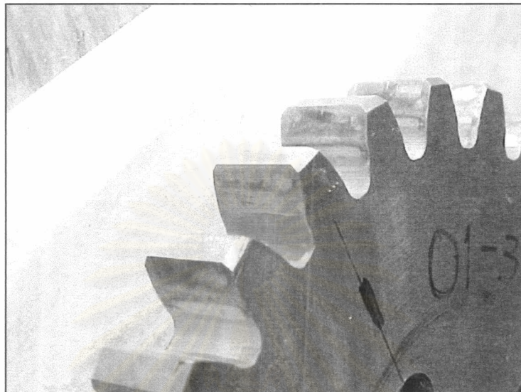
รูปที่ ค-5 ฟันซี่ที่มีรอยแตกร้าวเพียง 01-3 ฟันซี่ที่มีรอยแตกร้าวยาว 3.5 มม. ทาด้วยสีแดง
