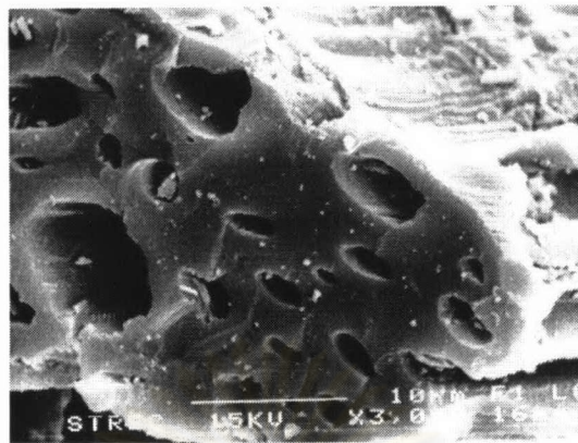
รูปที่ 4.3 ลักษณะโครงสร้าง พื้นผิว และรูพรุนของถ่านไม้แดง เมื่อใช้กำลังขยาย 3,000 เท่า
