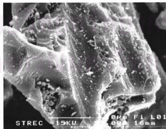
รูปที่ 4.5 ลักษณะโครงสร้าง พื้นผิว และรูพรุนของถ่านไม้แดงที่ผ่านการกระตุ้นด้วยกลีโกลและเผาที่ 400 องศาเซลเซียส เมื่อใช้กำลังขยาย 3,000 เท่า
