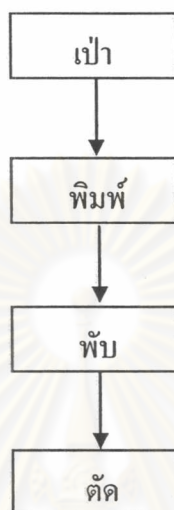
รูปที่ 3.3 รูปแสดงกระบวนการผลิตวัตถุดิบในส่วนพลาสติก
