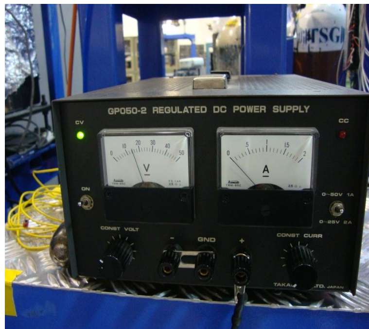
ภาพที่ 6 แหล่งจ่ายไฟฟ้า (Power supply) ใช้ในการเป็นแหล่งจ่ายแรงดันไฟฟ้าที่ใช้ในการทดลอง
