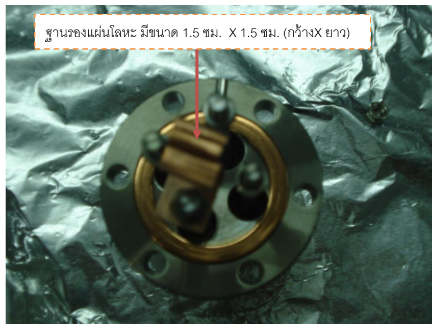
ภาพที่ 3.8.4 แสดงการสร้างหัววัดรังสีโดยใช้โลหะทั้ง 4 ชนิดในการทดสอบประสิทธิภาพของโลหะ
