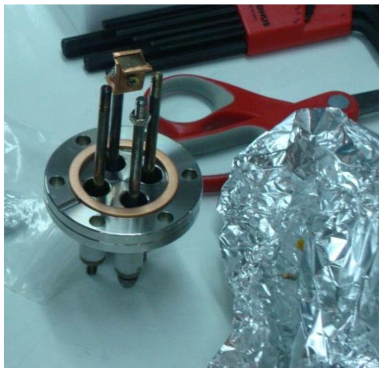
ภาพที่ 12 การเตรียมหัววัดรังสีเอกซ์ทริมอัลตราไวโอเล็ตที่ต้องใช้ในการทดลอง
