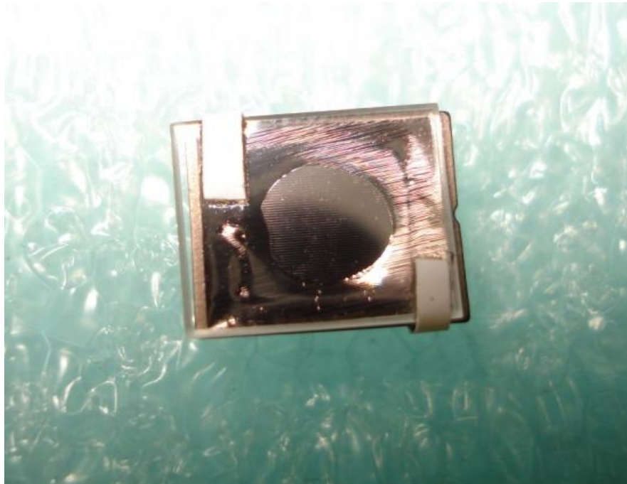
ภาพที่ 3.9.2 แสดงหัววัดรังสีชนิดโฟโตไดโอด SXUV HS5 Si/Zr. [13]
