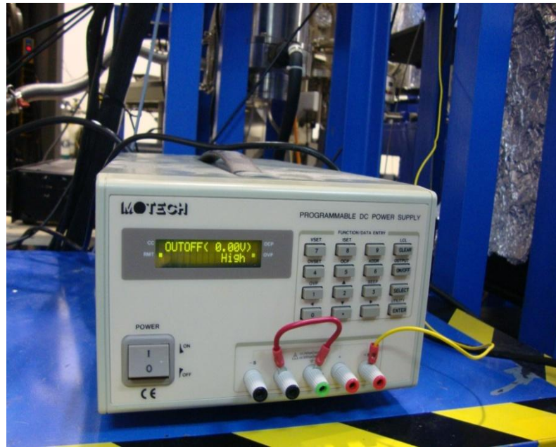
ภาพที่ 7 แหล่งจ่ายไฟฟ้า (Power supply) ใช้ในการเป็นแหล่งจ่ายแรงดันไฟฟ้าที่ใช้ในการทดลอง
