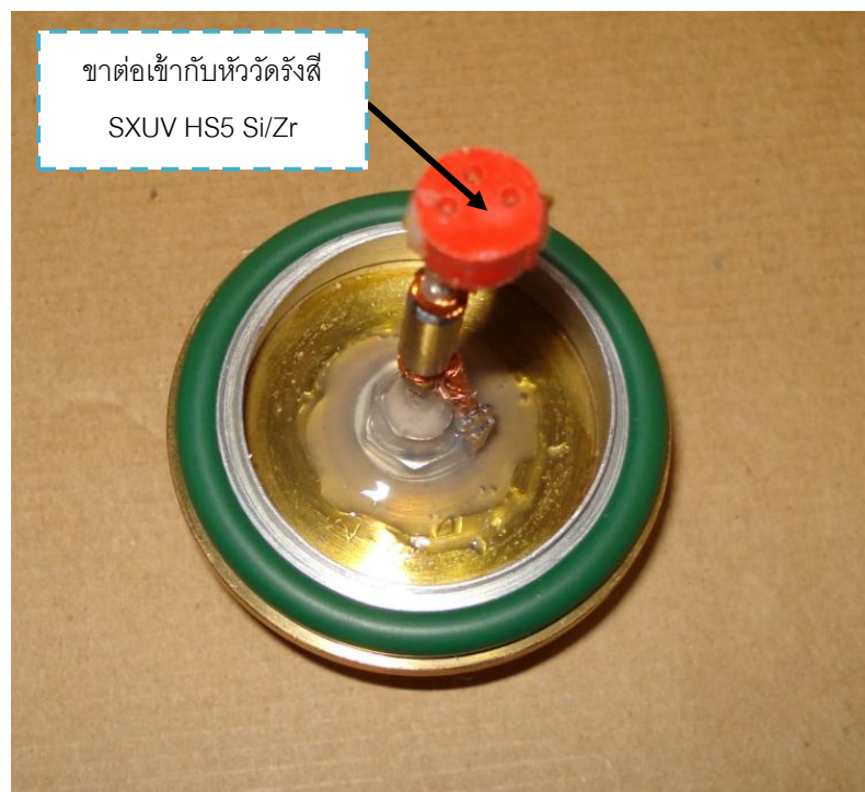
ภาพที่ 3.9.3 แสดงฐานของหัววัดรังสีชนิดโฟโตไดโอด SXUV HS5 Si/Zr. [13]
