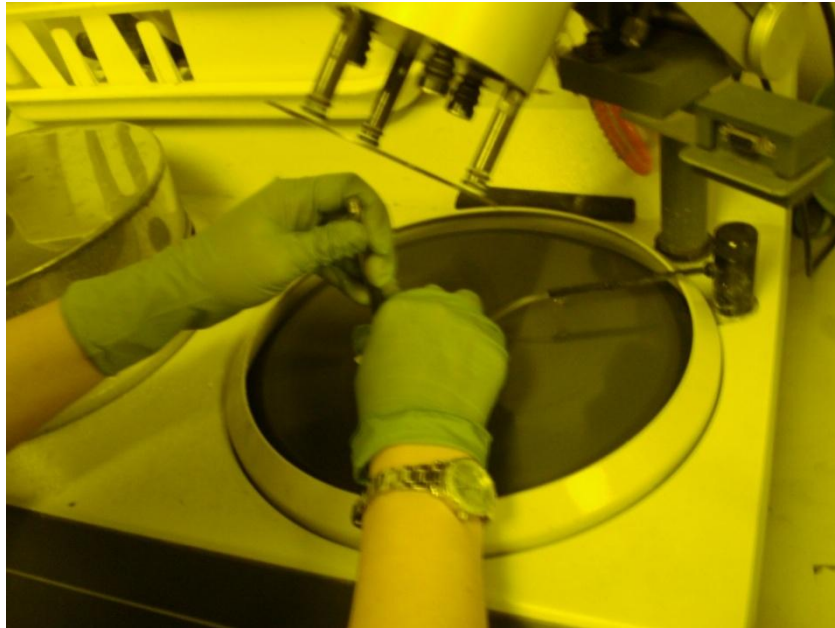
ภาพที่ 11 การขัดผิวหน้าโลหะที่จะนำมาสร้างหัววัดรังสีเอกซ์ทริมอัลตราไวโอเล็ต
