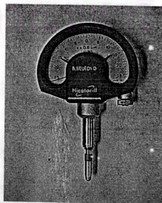
รูปที่ 4.7 Dial gage ความละเอียด 0.0005 มิลลิเมตร
