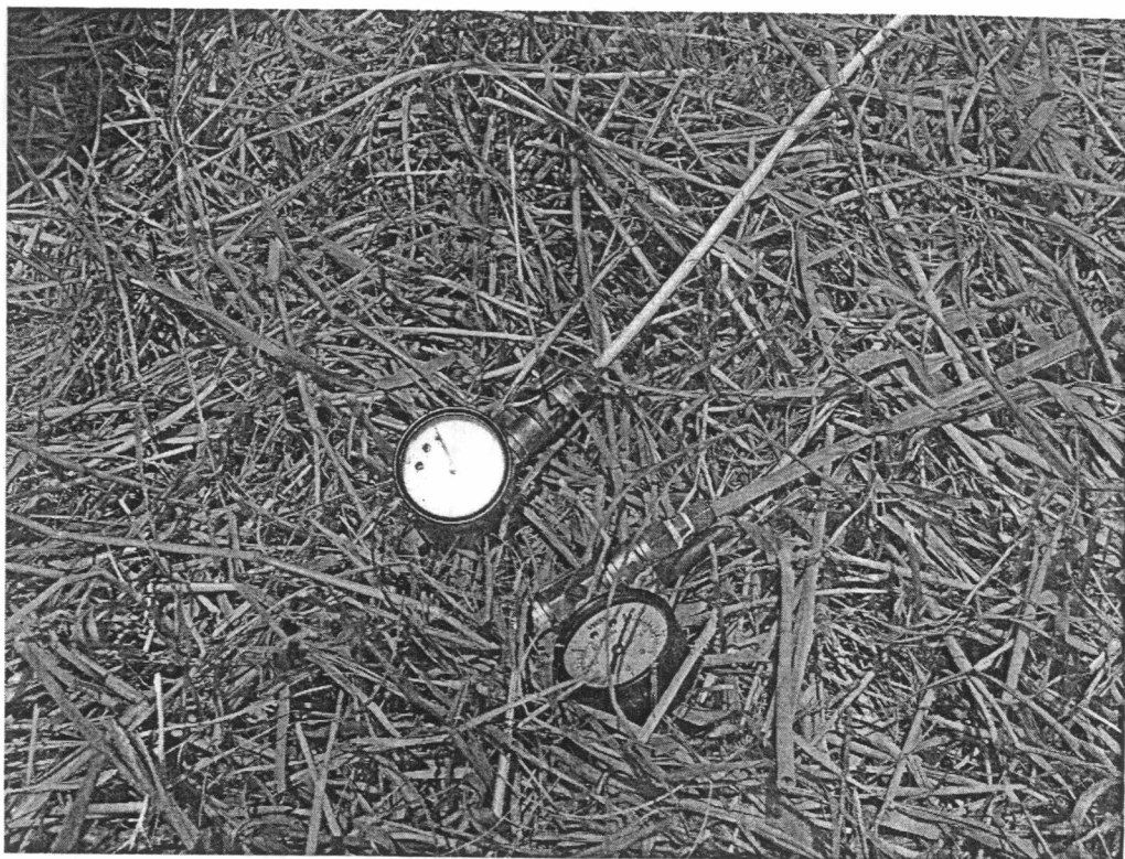
รูป ผ4 มาตรวัดแรงดันดิน (Pressure Meter)
