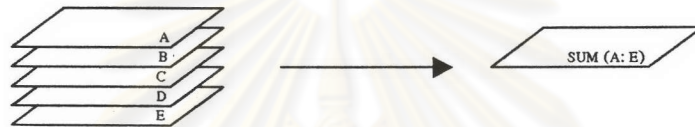
แผนภูมิ 3.2 การวิเคราะห์ข้อมูลโดยการซ้อนทับข้อมูลเชิงพื้นที่
