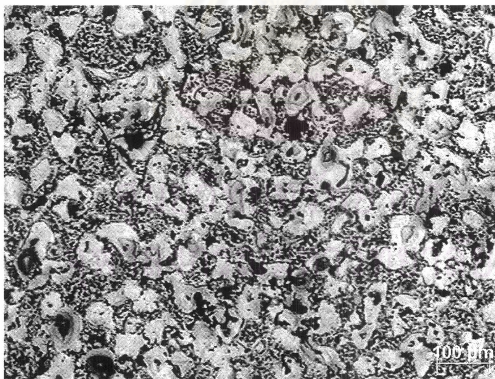
รูปที่ ข-4 ภาพถ่ายโครงสร้างจุลภาคของ 50 atom%Ni-Ti ที่ผ่านการเผาประสานที่อุณหภูมิ 900 °C เป็นเวลา 2 ชั่วโมง
