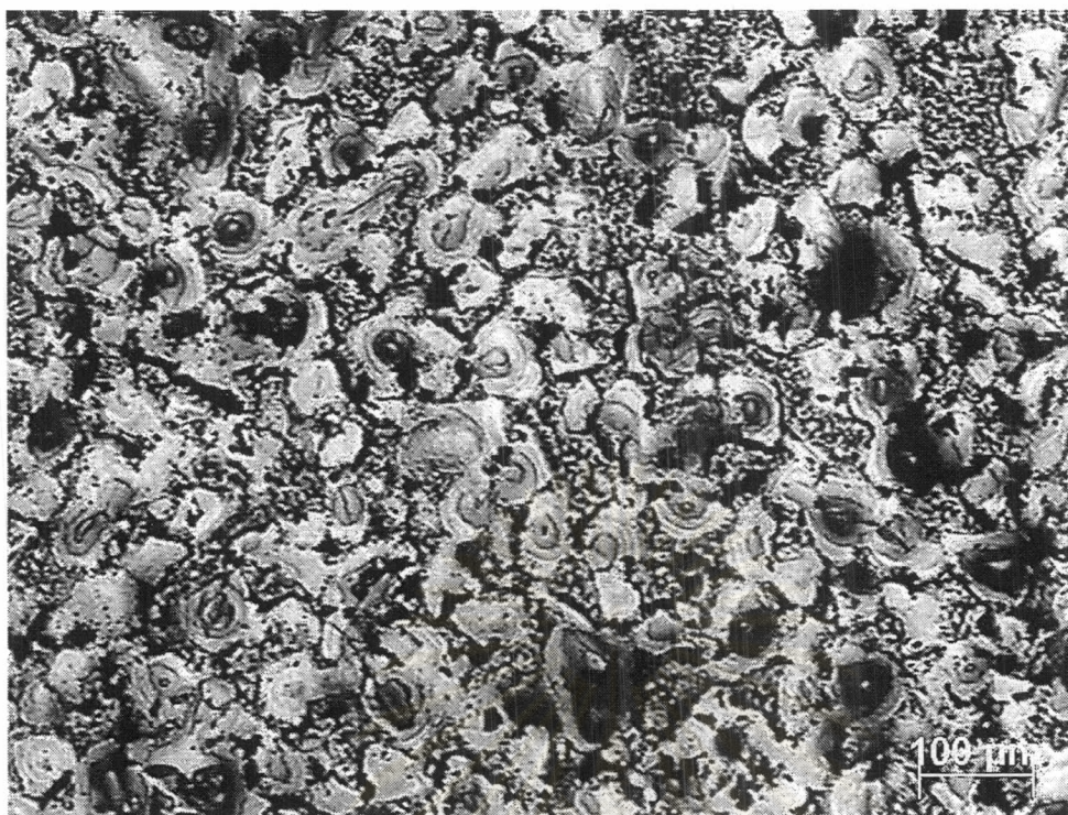
รูปที่ ข-3 ภาพถ่ายโครงสร้างจุลภาคของ 50 atom%Ni-Ti ที่ผ่านการเผาประสานที่อุณหภูมิ 800 °C เป็นเวลา 6 ชั่วโมง
