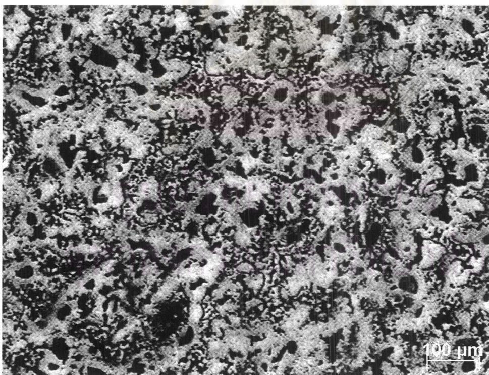
รูปที่ ข-8 ภาพถ่ายโครงสร้างจุลภาคของ 50 atom%Ni-Ti ที่ผ่านการเผาประสานที่อุณหภูมิ 1000 °C เป็นเวลา 4 ชั่วโมง
