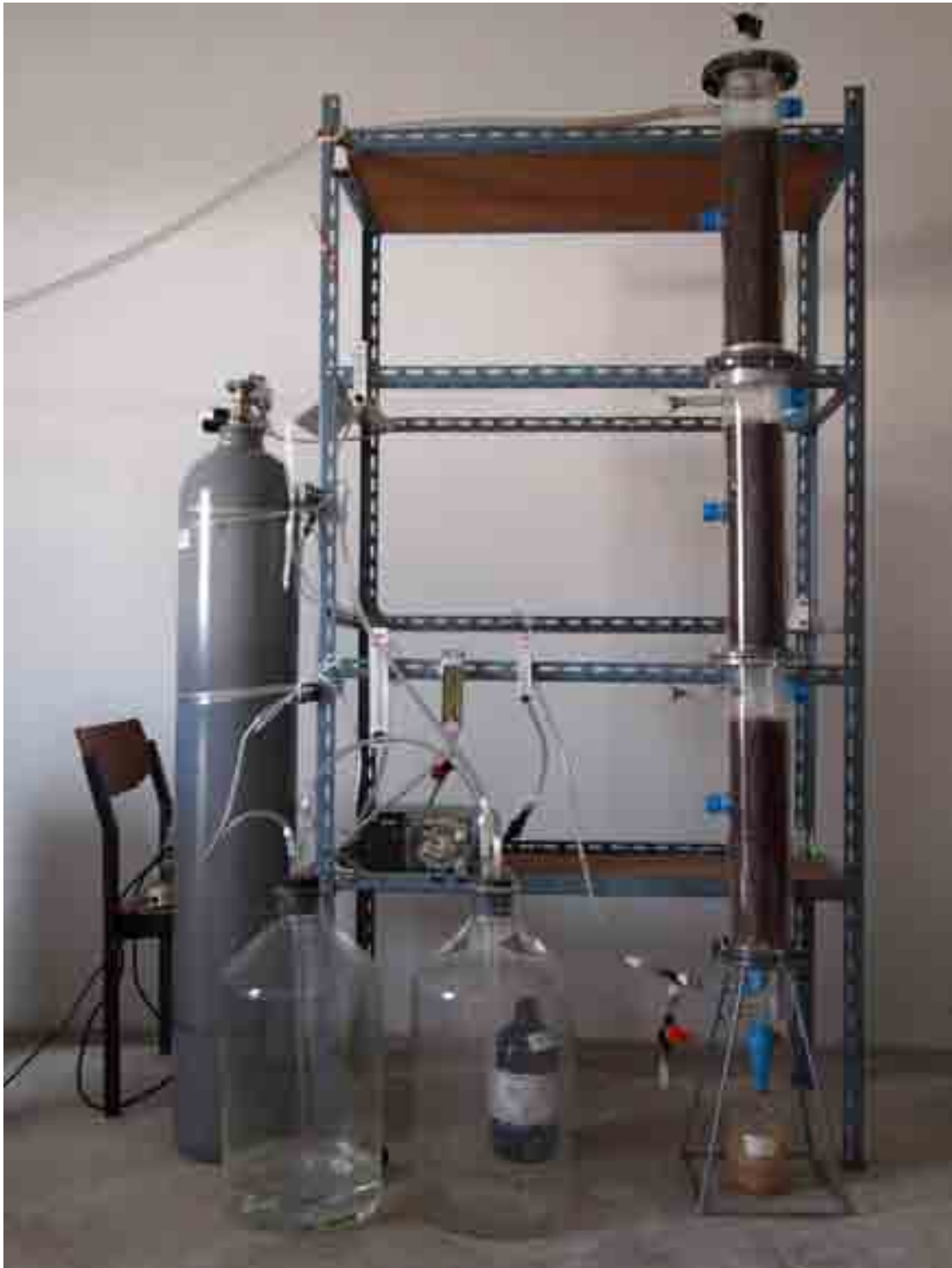
ภาพที่ 3.9 รูปชุดทดลองการกำจัดก๊าซแอมโมเนียร่วมกับก๊าซไฮโดรเจนซัลไฟด์
