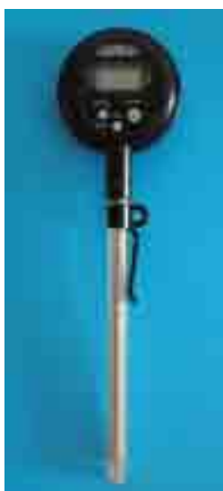
ภาพที่ 3.10 เครื่องวัดอุณหภูมิตัวกลาง
