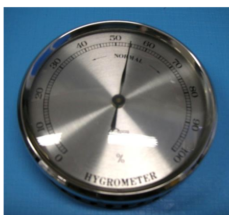
ภาพที่ 3.17 เครื่องวัดความชื้นสัมพัทธ์
