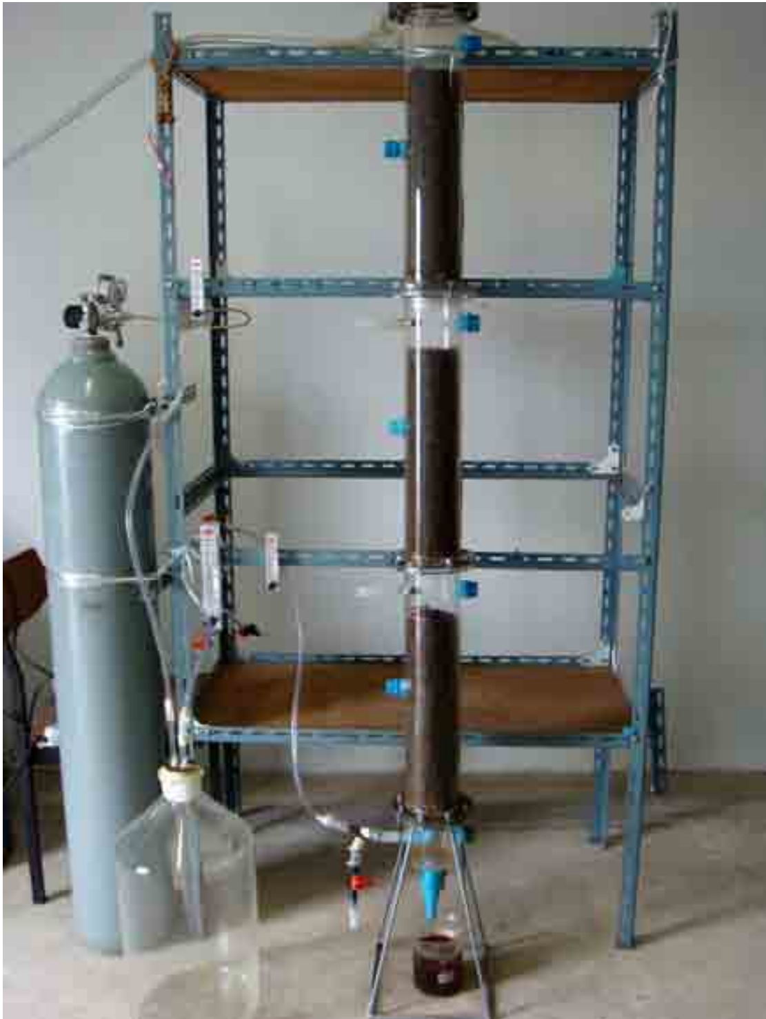
ภาพที่ 3.7 รูปชุดทดลองการกำจัดก๊าซแอมโมเนีย
