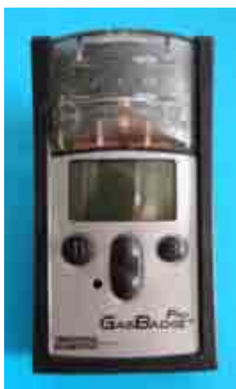
ภาพที่ 3.20 เครื่องวัดความเข้มข้นก๊าซแอมโมเนีย
