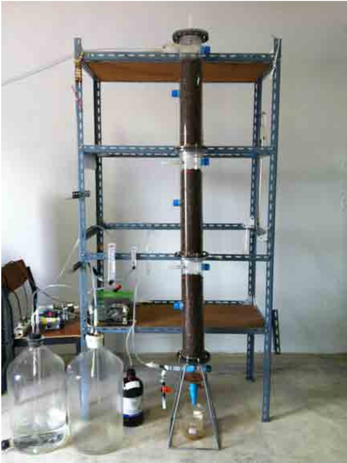
ภาพที่ 3.5 รูปชุดทดลองการกำจัดก๊าซไฮโดรเจนซัลไฟด์
