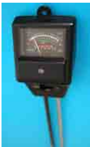
ภาพที่ 3.11 เครื่องวัดความชื้นตัวกลาง
