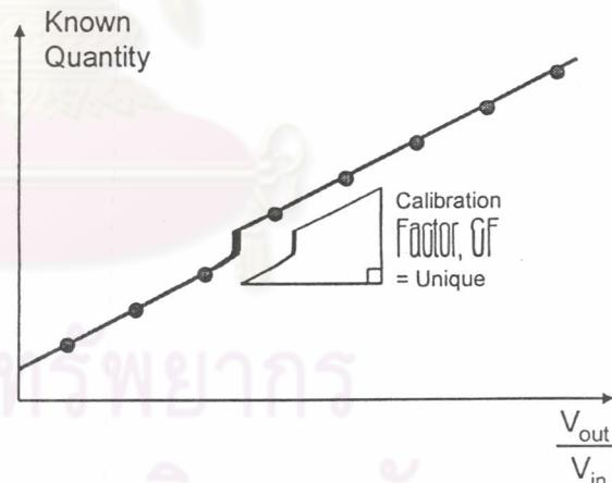
รูปที่ ก.1 Definition of Calibration Factor
