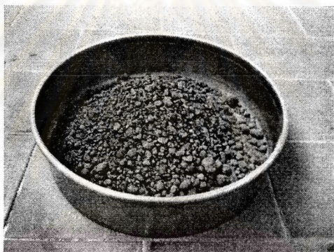
รูปที่ ๗8 เศษถ่านที่เผาไหม้ไม่สมบูรณ์ที่แยกออกหลังจากอบแห้ง
