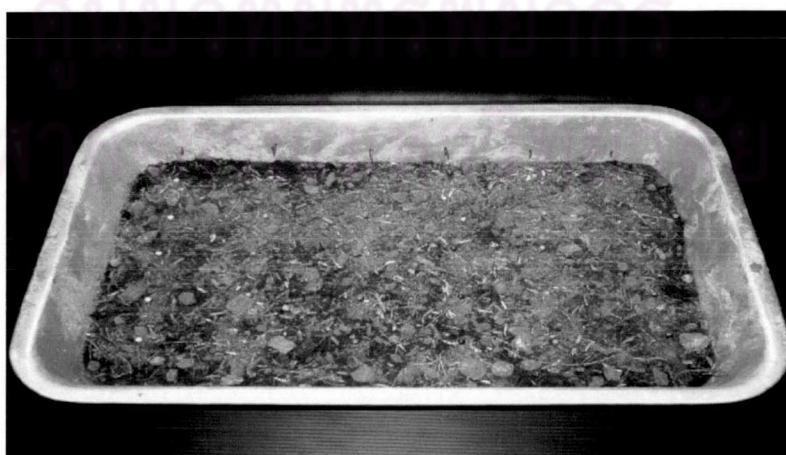
รูปที่ 3.7 การทดสอบความสามารถในการย่อยสลายทางชีวภาพโดยการฝังดิน
