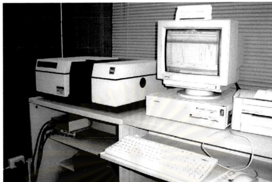
รูปที่ 3.3 เครื่องฟูเรียร์ทรานสฟอร์มอินฟราเรดสเปกโทรโฟโตมิเตอร์
