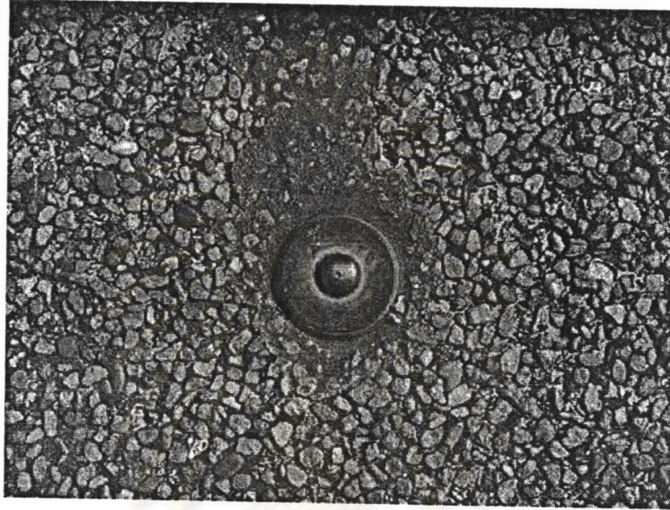
รูปที่ ก-1 ภาพหมุดBM 2 อยู่บริเวณทางขึ้นสะพานพระรามเจ็ด ผังกรุงเทพ ฯ
