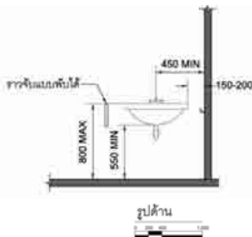
รูปที่ 2.4 แสดงระยะติดตั้งอ่างล้างมือ
