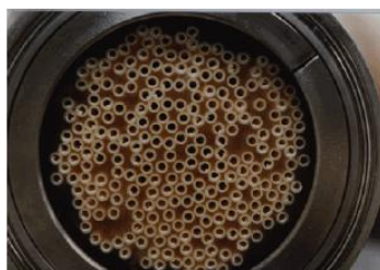
ภาพที่ 2-12 เมมเบรนแบบเส้นใยกลวง (Rachu, 2005)
