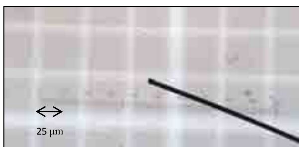
ภาพที่ 4-9 ภาพถ่ายอนุภาคน้ำมันตัดในน้ำเพอมิเอทที่ผ่านกระบวนการอัลตราฟิลเตรชัน
