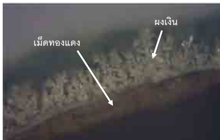
ภาพที่ 4.8 ภาพกล้องจุลทรรศน์แสงของอนุภาคเงินที่เกิดขึ้นบนผิวของเม็ดทองแดงจากปฏิกิริยาแลกเปลี่ยนประจุกันระหว่างซิลเวอร์ไนเตรตกับทองแดง ที่กำลังขยาย 500 เท่า
