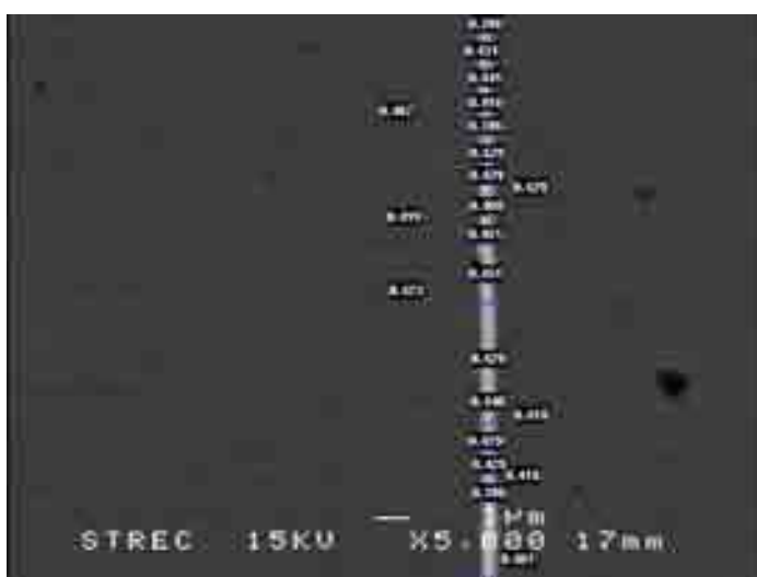
ภาพที่ ข ตัวอย่างการวัดความหนาของชั้นเงินเคลือบบนแผ่นทองแดงจากภาพ SEM ด้วยโปรแกรม SemAfore
