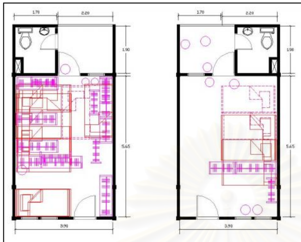
รูปภาพที่ 5.21 แสดงการการใช้พื้นที่ ในห้องผู้อยู่อาศัยกับคู่สมรสและบุตร โครงการเคหะชุมชนรามคำแหง TYPE – A , B
