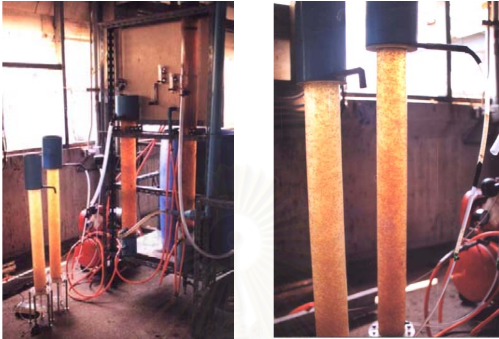
รูป 4.20 เครื่องปฏิกรณ์ชีวภาพฟลูอิด์เบด 3 เครื่องที่ต่อแบบอนุกรม ก แสดงภาพรวม การต่อเครื่องปฏิกรณ์ ข. แสดงสีในคอลัมน์ที่ 2 และ 3
