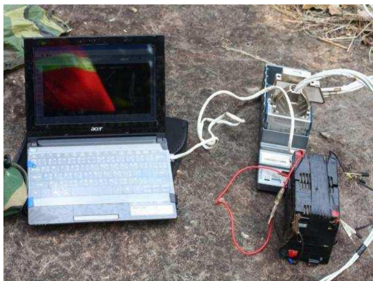
ภาพที่ 3-6 แสดงการติดตั้งเครื่องบันทึกข้อมูล
