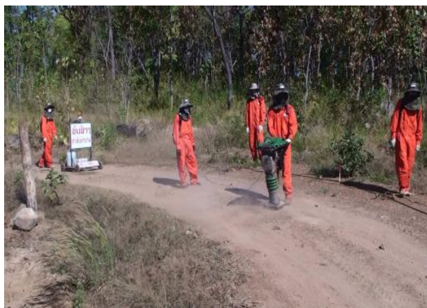
ภาพที่ 2-3 แสดงตัวอย่างการสำรวจโดยการใช้เครื่องกระทุ้งดิน (บริษัท เฟอร์ล ออย จำกัด, 2553)
