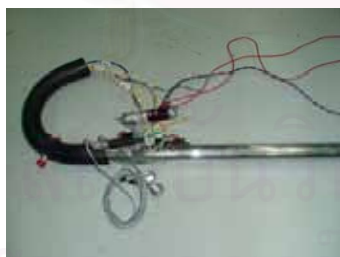
รูปที่ 3.13 การประกอบอุปกรณ์ต่าง ๆ เข้าไปในตัวไม้เท้า
