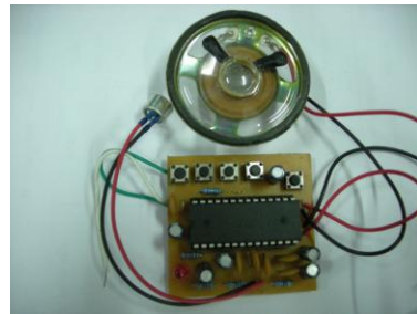
รูปที่ 2.16 แสดงการเชื่อมต่อของ ISD1700
