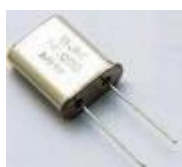
รูปที่ 2.6 – 2.7 แสดงลักษณะของ Quartz Crystal Oscillator และรูปวงจรที่ต่อกับ Capacitor
