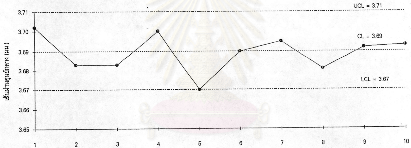
รูปที่ ๑-3 แผนภูมิควบคุม X-Chart สำหรับเส้นผ่านศูนย์กลางลวด
