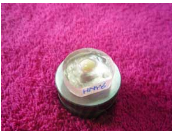
ภาพที่ 7 แสดงชิ้นตัวอย่างที่ยึดติดกับฐานโลหะ
