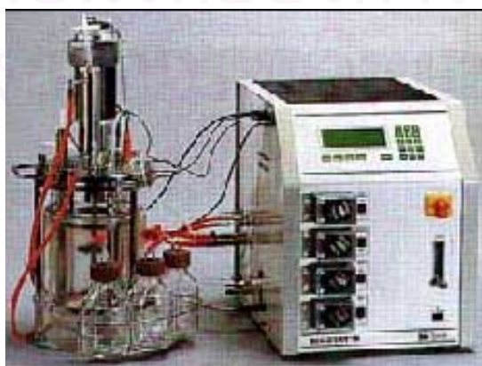
รูปที่ 33 เครื่อง fermenter รุ่น Biostat® B ขนาด 5 ลิตร ที่ใช้ในการทดลอง
