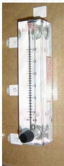
รูปที่ 3.6 อุปกรณ์วัดและควบคุมอัตราการไหลของอากาศที่ตำแหน่งช่องเติมอากาศ
