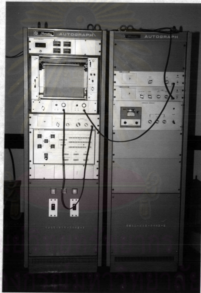
รูปที่ 20 แสดงเครื่องยูนิเวอร์แซลทดสอบดึงมะชิน ส่วนที่เป็นตัวควบคุมและเขียนกราฟ
