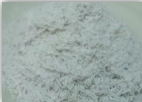
รูปที่ 4.2 เถ้าขาวที่ผ่านการเผาด้วยอุณหภูมิ 700 องศาเซลเซียสเป็นเวลา 2 ชั่วโมง
