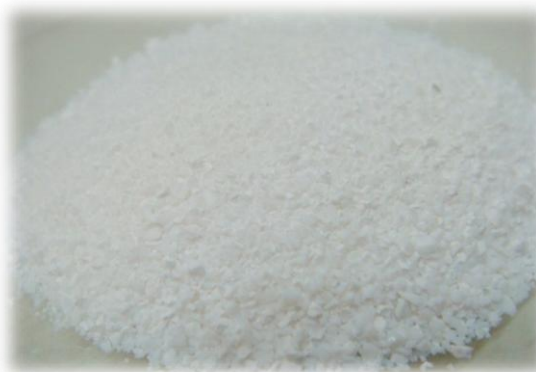
รูปที่ 4.5 ผงซิลิกาเจลที่ได้จากการสังเคราะห์จากแกลบและผ่านการคั้ดขนาด
